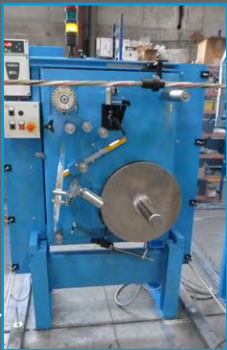
Taping (szalagtekercselés): koncentrikus & hosszanti
