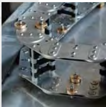
LZ94 típusú energialánc: körbeforgó alkalmazás robbanásbiztos ATEX Zóna 2 előírásnak megfelelő kivitelben
