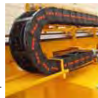
LC85 típusú műanyag (nylon) energialánc fűrőgépen telepítve
